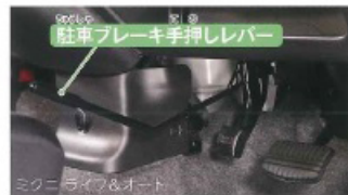
駐車ブレーキ手押しレバー ミクニライフ&オート 駐車ブレーキペダルにとりつけた「駐車ブレーキ手押しレバー」によって、手で駐車ブレーキをかけることができる。
